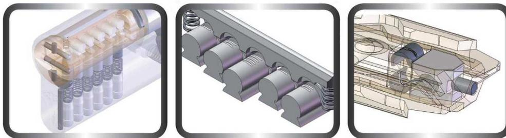
**1. Телескопические пины** - цилиндры имеют уникальную систему внешних и внутренних телескопических пинов. Для открытия механизма цилиндра необходимо, чтобы было соблюдено непростое условие - внешние и внутренние пины были одновременно разблокированы – выстроены в единую линию.
