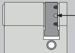
B) Feder in der Schließnase mit einem stabilen, spitzen Gegenstand herunterdrücken und Schließnase neu ausrichten.
