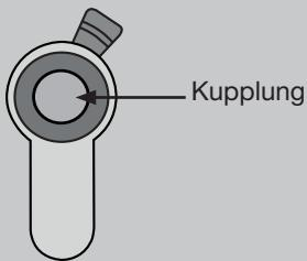
2. Schlüssel drehen bis die Schließnase auf 6 steht. Profil-Halbzylinder in das Vorhangschloss einsetzen.
