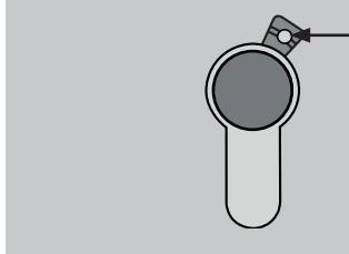
C) Die Kupplung auf der Rückseite des Profil-Halbzylinders eindrücken und die Schließnase in Position bringen.
