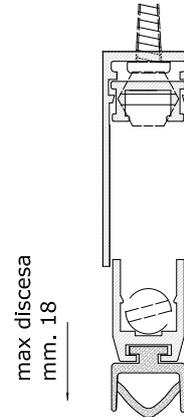
**Функции:** автоматическое закрытие щели между дверью и полом для защиты от сквозняков, проникновения пыли, насекомых, дыма, а также с целью звукоизоляции.
